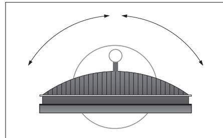
Если телевизор установлен на подставке с электроприводом или на настенном кронштейне, его можно отклонять вверх или наклонять вниз (однако, делать это можно только вручную).
